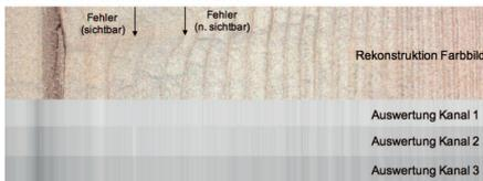
Abbildung 18: Beispielhafte Darstellung von wahrnehmungsorientierter Digitaldruckinspektion (vgl. [1]).
