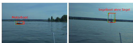
Figure 45: Detektierte Bounding-Boxen und Objektklassen (rot) sowie die zugehörigen Annotationen (grün).
