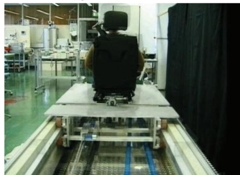
Abbildung 16: Verschiedene Ansichten des Aufprallsimulators im Labor für Messtechnik und Sensorik.
