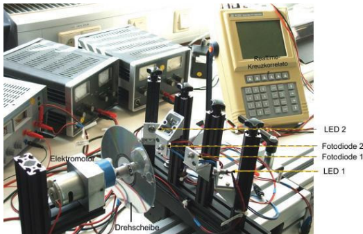
Abbildung 5: Versuchsaufbau zur optischen Drehzahlmessung mit dem Korrelationsverfahren.
