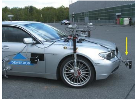
Abbildung 3: Optisches Messsystem zur Geschwindigkeitsmessung an der Vorderfront des Fahrzeugs [1].
